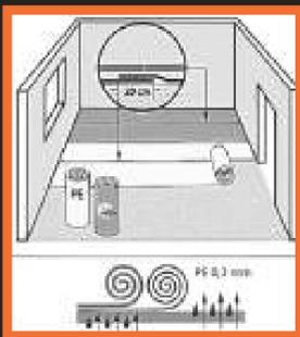
При укладке ламинированных полов необходимо обеспечить гидропароизоляцию основания (полиэтиленовая плёнка 0,2 мм). После этого расстилается подложка для компенсации неровностей основания и обеспечения комфорта при эксплуатации (1-3 мм). Укладка гидропароизоляции и подложки осуществляется внахлёт не менее 20 см или встык при помощи клейкой ленты (рис. 1).
