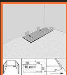
Монтаж начинается с формирования первого ряда с правого угла. Панели укладываются гребнем к стене. Необходимо соблюдать монтажные деформационные зазоры: не менее 10 мм от края покрытия до стен (рис. 2).
