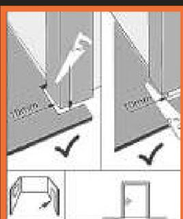
При огибании труб необходимо соблюдать монтажные деформационные зазоры не менее 10 мм от края покрытия до трубы (рис. ???).
